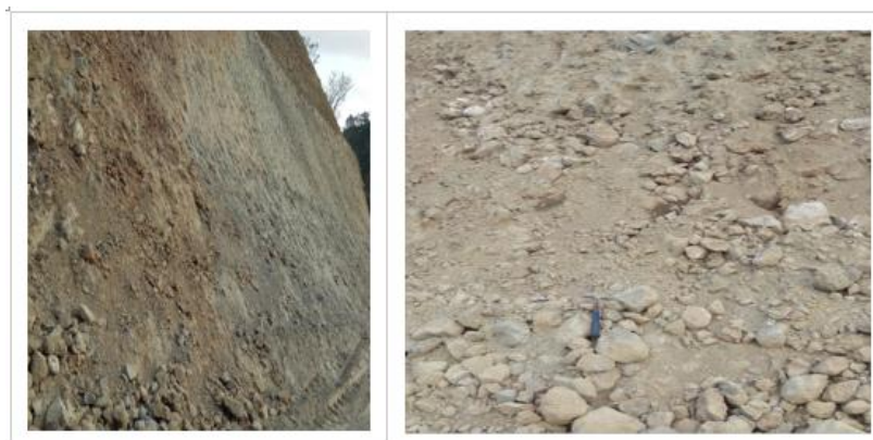
Gambar 9: Singkapan satuan batuan beku vulkanik Dasitic KK-HW, Kordinat Lokasi Sampel X: 0205865;Y: 9147519; Z: 239m
