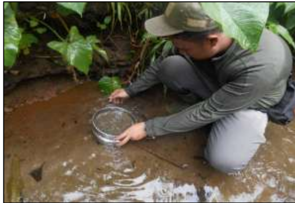
Gambar 1. Pengambilan contoh sedimen sungai menggunakan saringan 80 #
