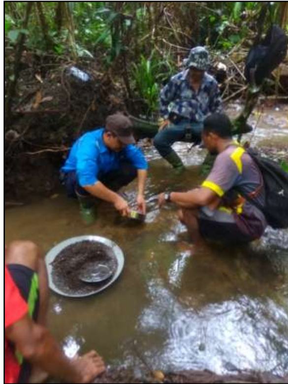
Gambar 3. Pengambilan contoh geokimia sedimen sungai menggunakan saringan 80 #
