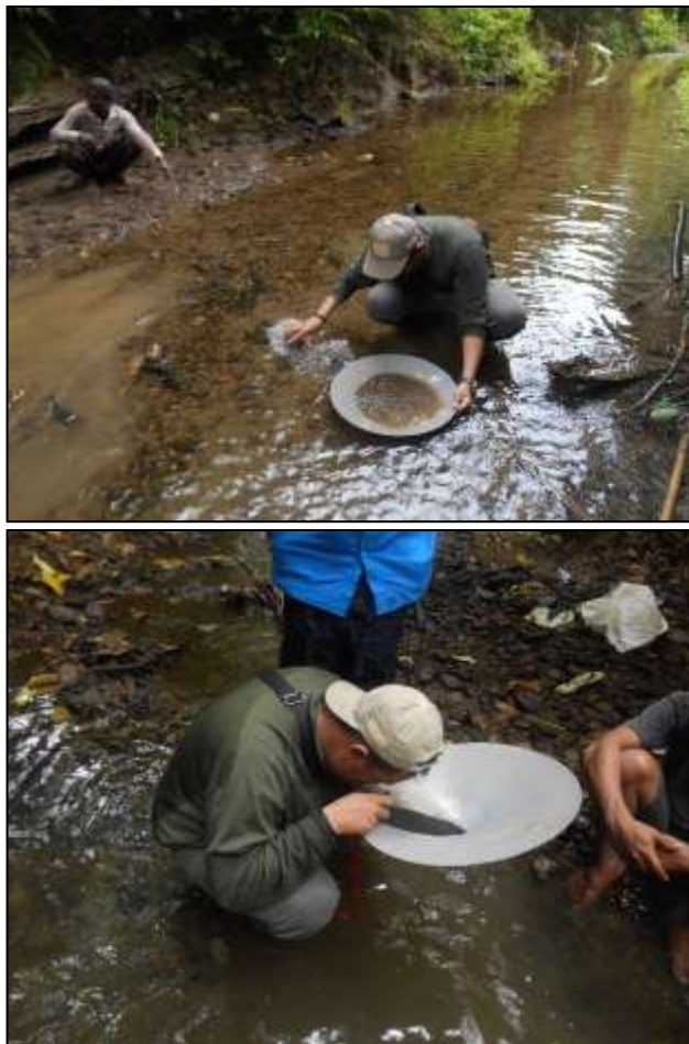
Gambar 2. Pendulangan dan pengamatan mineral berat
