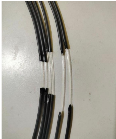
Gambar 8. POF dengan Variasi Panjang 2, 3, 4 cm
