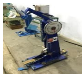
Gambar 4. Alat uji kekuatan impact metode Charpy
