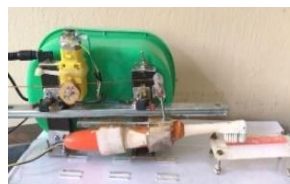
Gambar 3. Penyikatan lempeng nilon termoplastik dengan pasta daun tembakau.
