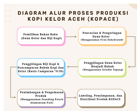
Gambar 4. Diagram Alur Proses Produksi Kopi Kelor Aceh
