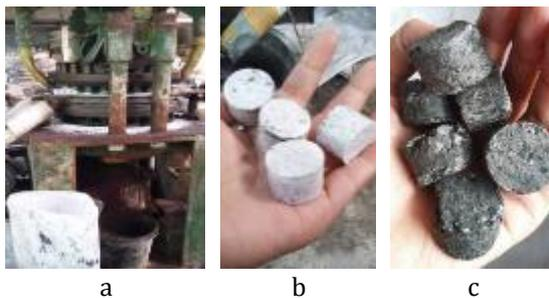
**Gambar 1** Mesin Pencetak Pupuk (a), Urea dan Zeolit (b), Urea - Zeolit - Arang aktif (c).
